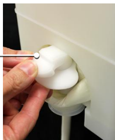
Figure 37: Raccourcissement et fixation du bouchon
