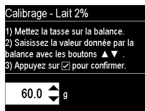
Figure 52: Poids attendu lors de la deuxième distribution-test du calibrage
