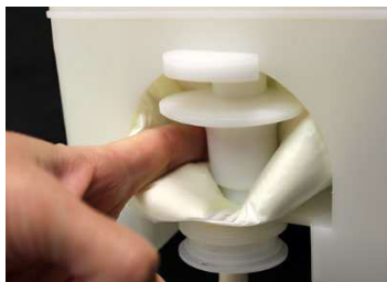
Figure 38: Confirmation de la bonne installation du bouchon
