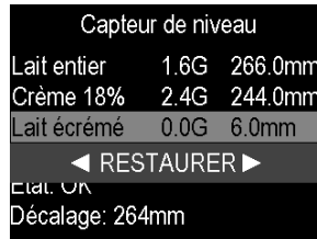
Figure 87: Réinitialisation du capteur de niveau
