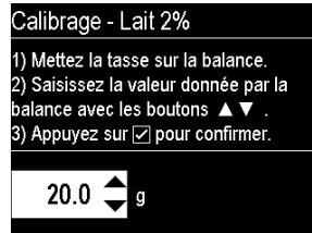
Figure 51: Poids attendu lors de la première distribution-test du calibrage
