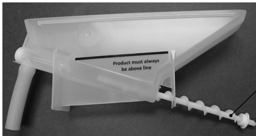
Figure 15 : Retrait de la vis sans fin hors de l'arrière de la trémie
